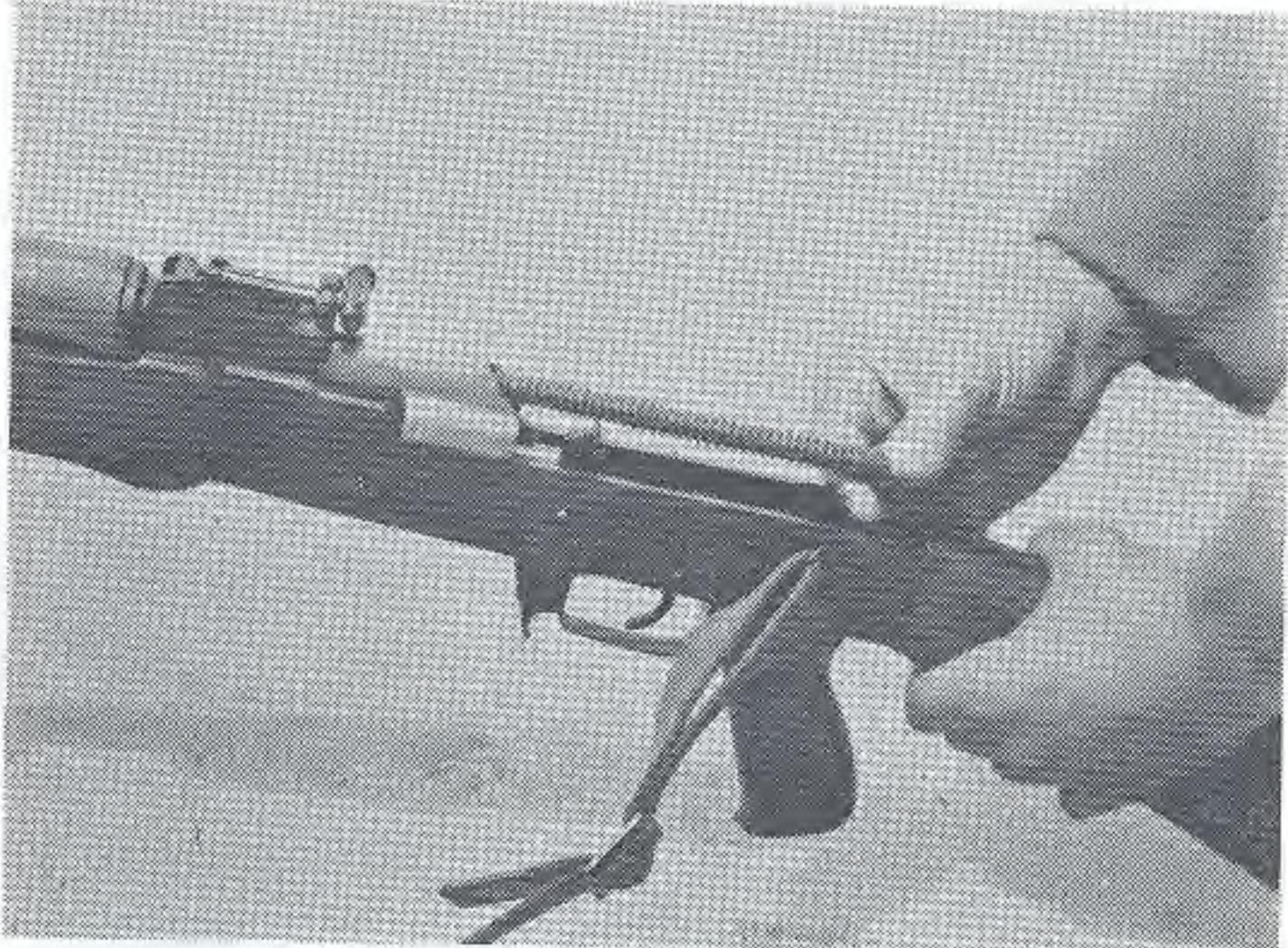
Sl. 62 – Odvajanje povratnog mehanizma
